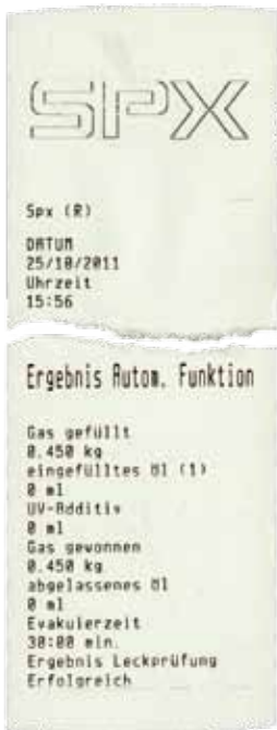
450 Gramm Kältemittel entnommen, 450 Gramm Kältemittel eingefüllt: das Protokoll des ersten R-1234yf-Klimaservices
