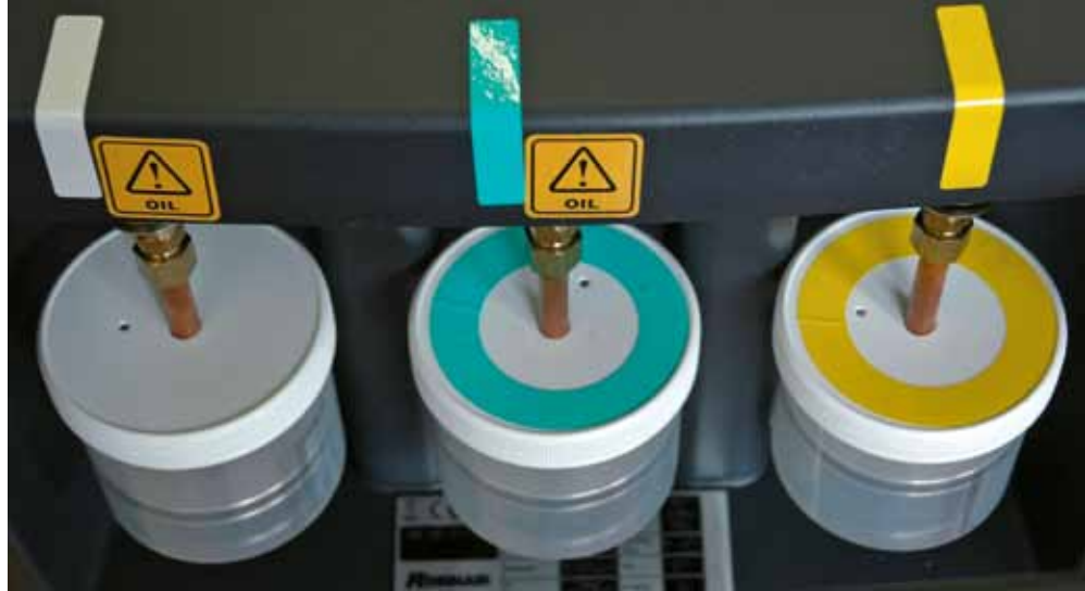
Das Robinair-Klimaanlagen-Servicegerät besitzt zwei Behälter für unterschiedliche Kompressoröle
